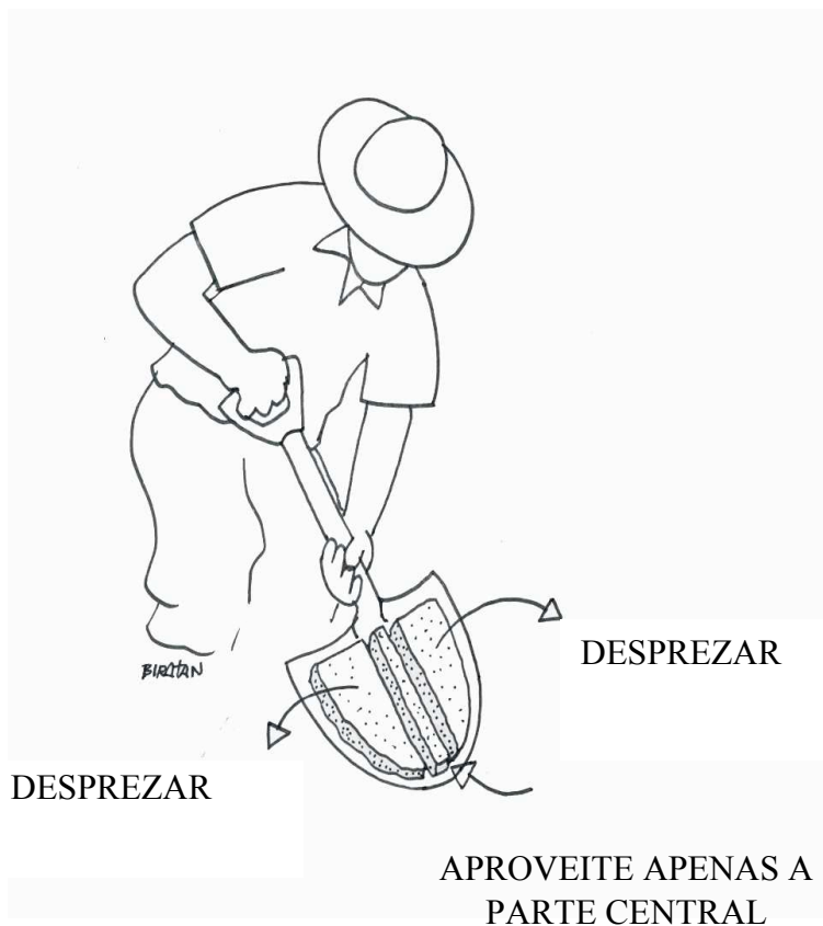
Figura 4 - Amostragem realizada com pá para escavação.
